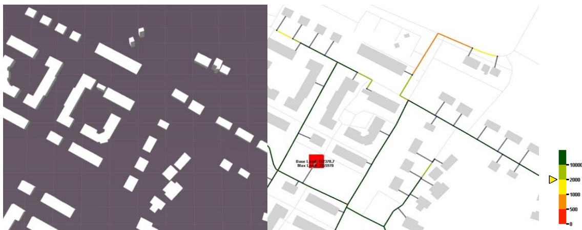
Abb. 4.7 Visualisierung des Untersuchungsgebiets in der CDP // Collaborative Design Platform (links) und der Wärmeabnahme pro Trassenmeter in kWh/Trm*a (rechts)
